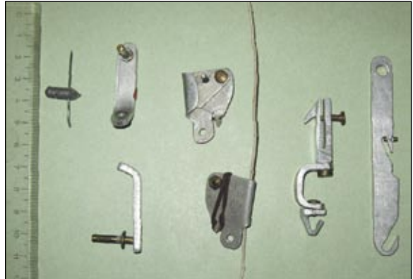
Obr. 2. Príslušenstvo na upevnenie meracieho zariadenia na meračský bod. Foto: Z. Hochmuth
