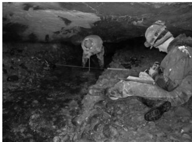
Obr. 4. Hydrometrovacie práce v jaskyni Štefanová – profil J3. Foto: D. Haviarová Fig. 4. Measurement of discharges by current meter in the Štefanová Cave – profile J3. Photo: D. Haviarová
