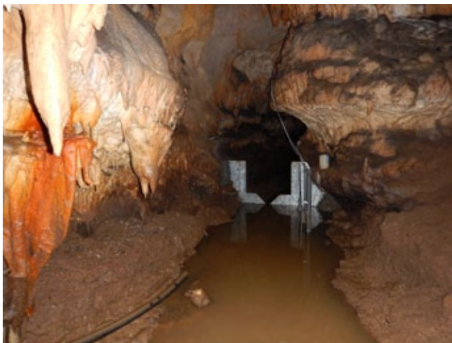
Obr. 2. Merný priepad na Styxe v Panenskej chodbe. Foto: D. Haviarová Fig. 2. The water-gauging station on the Styx River in the Panenská chodba Passage. Photo: D. Haviarová
