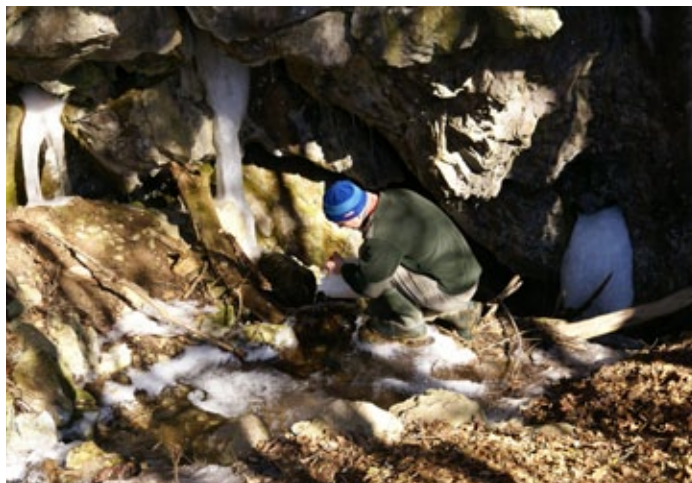
Obr. 10. Aplikácia stopovača v ponore P1.
