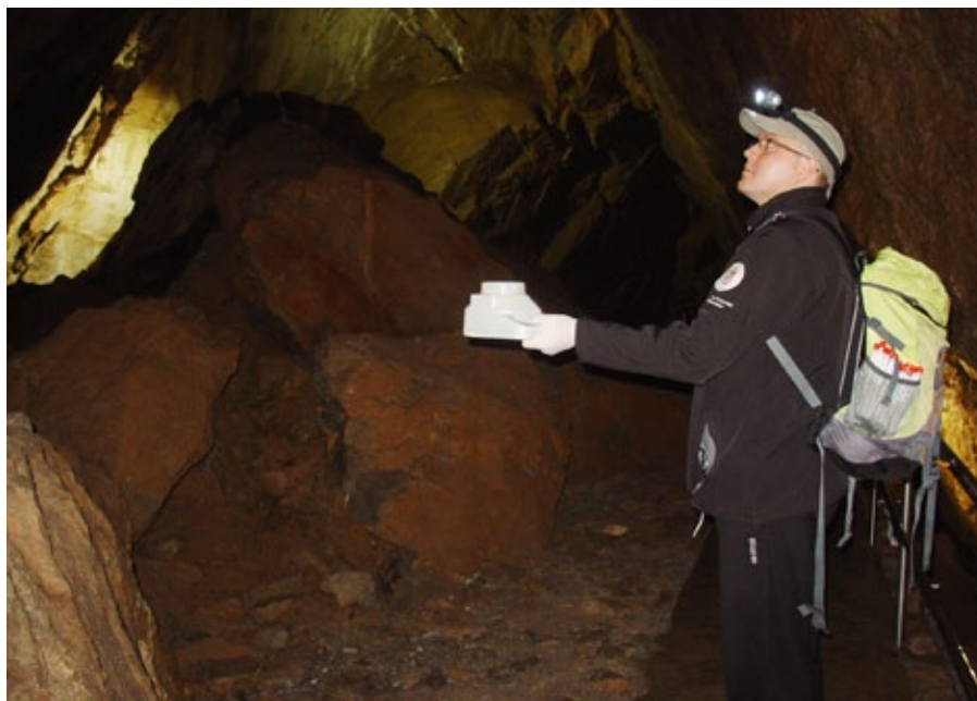
Obr. 1. Aktívne nasávanie vzduchu aeroskopom, Harmanecká jaskyňa. Foto: Z. Višňovská Fig. 1. Active aspiration of air using an aeroscope, Harmanecká Cave. Photo: Z. Višňovská
