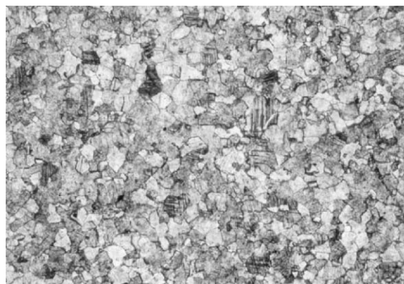
Obr. 3. Mikrofotografia sparitu rekryštalizovaného alodapického vápenca zo vstupnej chodby. Mikrofoto: J. Psoťka Fig. 3. Microphoto of sparite recrystallized allodapic limestone from the entrance corridor. Photo: J. Psoťka
