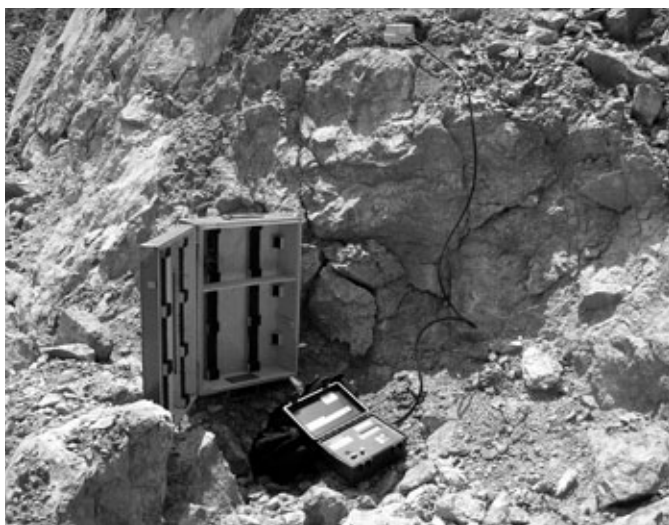
Obr. 7. Digitálny štvorkanálový seizmograf VMS 2000 MP firmy THOMAS INSTRUMENTS a trojzložkový seizmosnímač americkej firmy Geospace (vpravo) inštalovaný na podložke s oceľovými hrotni – meracie stanovište 1. Foto: B. Pandula Fig. 7. Four-channel digital seismograph VMS 2000 MP of the Company THOMAS INSTRUMENTS and three component geophone of the American company Geospace (right) mounted on a base with steel spikes – the measuring site No. 1. Photo: B. Pandula
