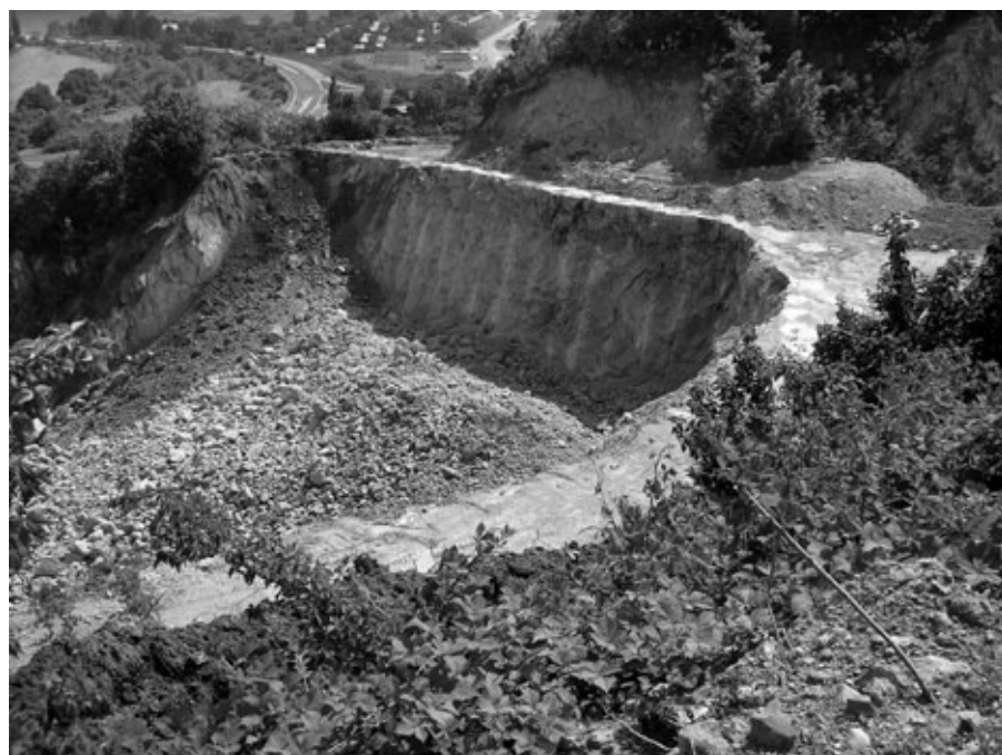
Obr. 4. Prevádzkový clonový odstrel CO 24 v lome Brekov situovaný vo vzdialenosti 376 m od Brekovskej jaskyne. Foto: B. Pandula
