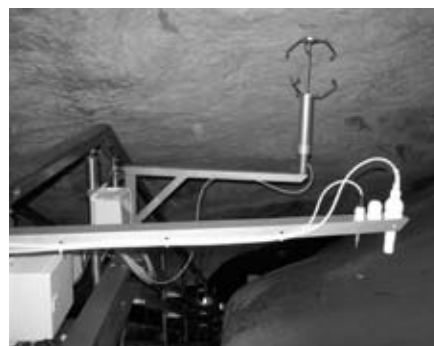
Obr. 3. Meranie pomalých prúdení vzduchu ultrasonickým 3D anemometrom (Dobšinská ľadová jaskyňa, Ľadopád). Foto: J. Zelinka Fig. 3. Measuring of slow air movements by ultrasonic 3D anemometer (Dobšinská Ice Cave, Ice-fall). Photo: J. Zelinka
