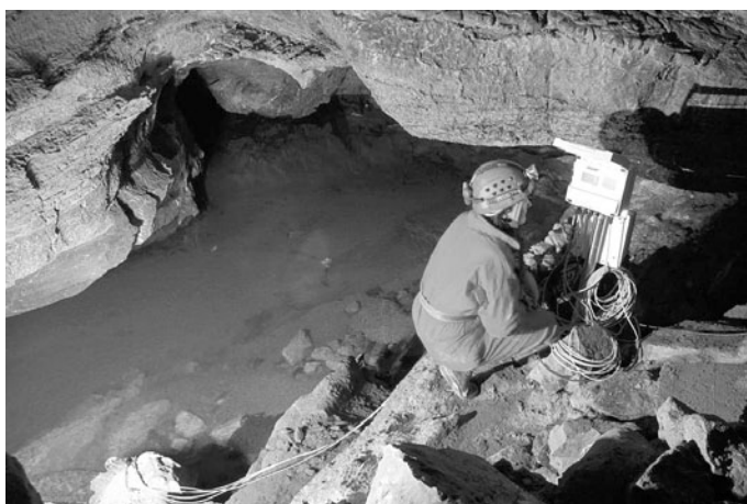
Kontinuálny monitoring kvality vôd v Demänovskej jaskyni slobody. Foto: P. Staník
