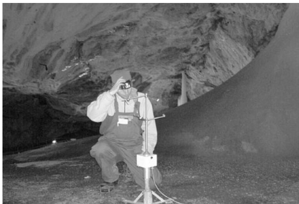
Meranie pomalých prúdení vzduchu v spolupráci s Vroclavskou univerzitou (Poľsko), Malá sieň v Dobšinskej ľadovej jaskyni. Foto: J. Zelinka
