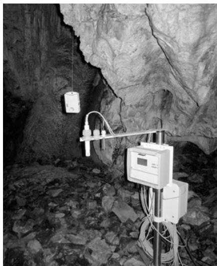
Dve technické úrovne speleoklimatického monitorovania – pomocou „čiernej skrinky“ (vľavo) a automatickej stanice z nového integrovaného monitorovacieho systému, Medvedia chodba v Demänovskej ľadovej jaskyni. Foto: J. Zelinka
