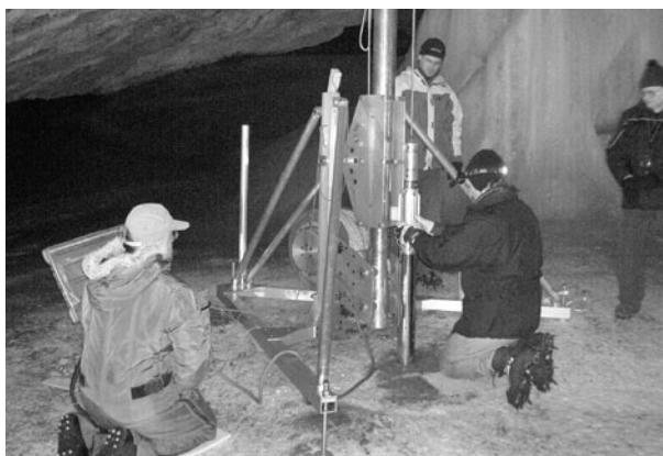
Medzinárodný tím pri vŕtaní ľadu na jeho geochemický a izotopový výskum, Veľká sieň v Dobšinskej ľadovej jaskyni. Foto: J. Zelinka
