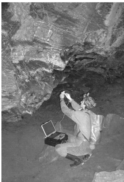
Prenos zaznamenaných údajov mikroklimatického monitoringu z datalogra do PC, Plochá sieň v Liskovskej jaskyni. Foto: D. Haviarová
